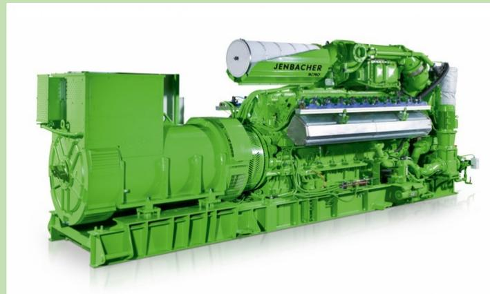
ガス) では、1,500KWe の発電が可能ですが、合成ガス熱量がバイオガスの 2.5 分の 1 程度と低く、最大 900KWe 程度迄発電出力は低下します。何れにしても、バイオマス・ガス化炉合成ガス用として世界的に最も有名であり、実績も多く高効率な Jenbacher 製ガス・エンジン発電機 (J420) を 850~900KWe 発電用として標準的に採用しています。
